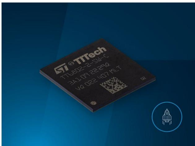
*STMicroelectronics intègre l'IP de TTTech dans ses puces ST33 qualifiées pour les applications spatiales et utilisées par les clients de TTTech dans des programmes spatiaux tels que le lanceur européen Ariane 6 ou la station Gateway de la NASA. (© TTTech)*
