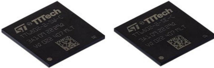
Légende : les TTESwitch and TTEEnd System Controller HiRel ASIC de TTTech Aerospace sont utilisés pour connecter plus de 50 sous-systèmes à un réseau TTEthernet® redondant unique, le « système nerveux » du lanceur (© TTTech Computertechnik AG)
