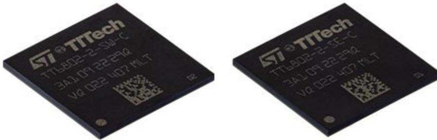
Bildunterschrift: Die TTESwitch und TTEEnd System Controller HiRel ASICs von TTTech Aerospace werden verwendet, um mehr als 50 Subsysteme mit einem einzigen, redundanten TTEthernet®-Netzwerk zu verbinden, dem „Nervensystem“ der Ariane 6 Trägerrakete (© TTTech Computertechnik AG).
