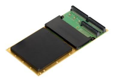
Légende : La carte <sup>TTE</sup>End System A664 Pro (PMC) certifiable de TTTech Aerospace a été intégrée avec succès dans un système avionique pour véhicules aériens sans équipage mis à niveau. (© TTTech Computertechnik AG)
