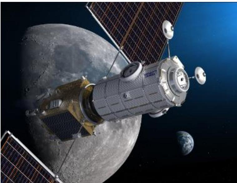
**Légende :** Représentation conceptuelle du module logistique et d'habitation HALO (à droite) et de l'élément d'alimentation et de propulsion PPE (à gauche) de la Gateway en orbite lunaire (droit d'auteur : Northrop Grumman)
