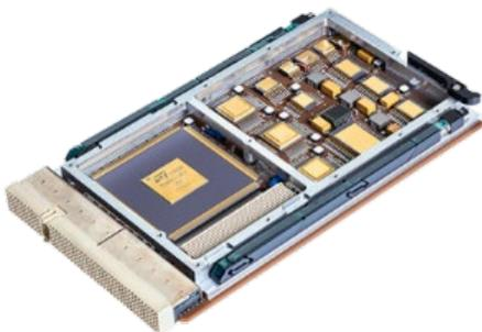
**Légende :** Le TTEnd System Space 3U cPCI : l'un des composants de la plate-forme réseau et de calcul de TTTech Aerospace (droit d'auteur : TTTech Computertechnik AG)
